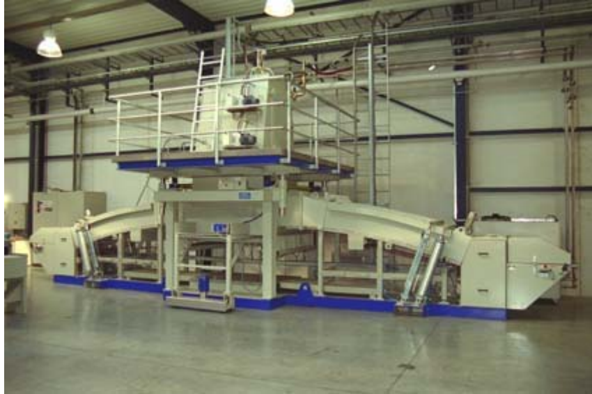
Bild 9 ESH Anlage zur Bestrahlung von Plattenmaterial. Die Abschirmung von Ein und Auslauf erfolgt über „Bogen- Transport“.
